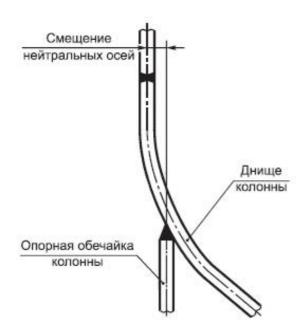
Рисунок 4 - Узел соединения опорной обечайки и днища аппарата
