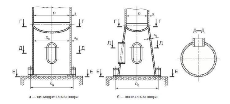
Рисунок 2 - Расчетные сечения опорной обечайки
