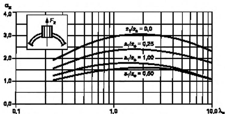
Рисунок Б.10 — Коэффициенты концентрации  $\alpha_z$  в месте пересечения проходящего штуцера со сферической оболочкой при осевом усилии на штуцер в зависимости от  $\lambda_s$  и отношения  $s_1/s_2$
