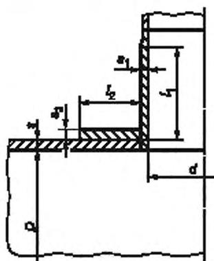
Рисунок А.4 — Укрепление отверстий накладным кольцом
