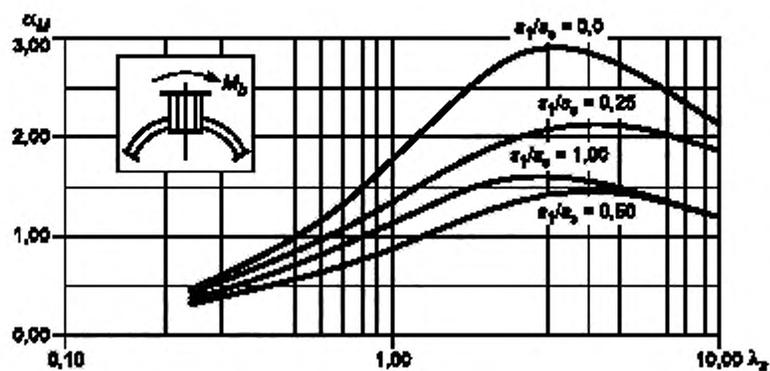
Рисунок Б.12 — Коэффициенты концентрации  $\alpha_M$  в месте пересечения проходящего штуцера со сферической оболочкой при нагружении штуцера изгибающим моментом в зависимости от  $\lambda_2$  и отношения  $s_1/s_2$
