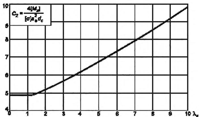
Рисунок Б.3 — График для определения  $C_2$
