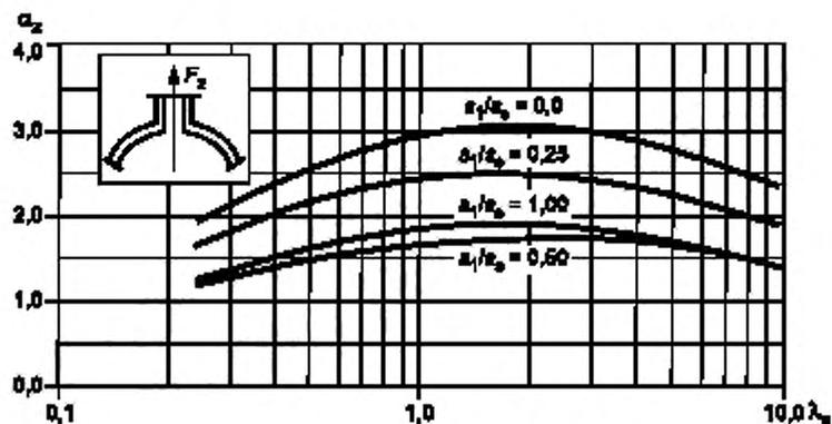
Рисунок Б.9 — Коэффициенты концентрации  $\alpha_z$  в месте пересечения штуцера со сферической оболочкой при осевом усилии на штуцер в зависимости от  $\lambda_s$  и отношения  $s_1/s_2$
