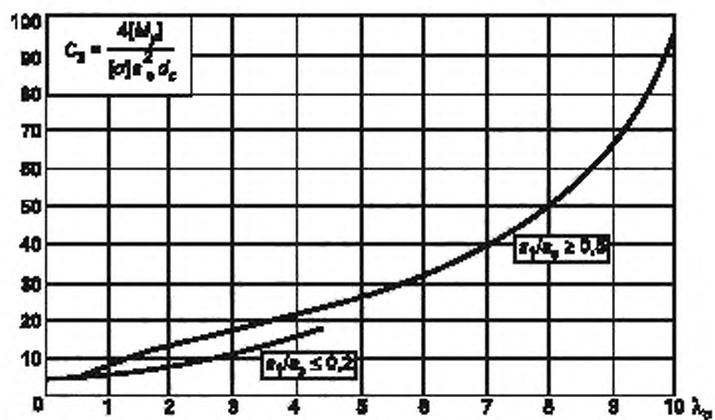
Рисунок Б.4 — График для определения  $C_3$
