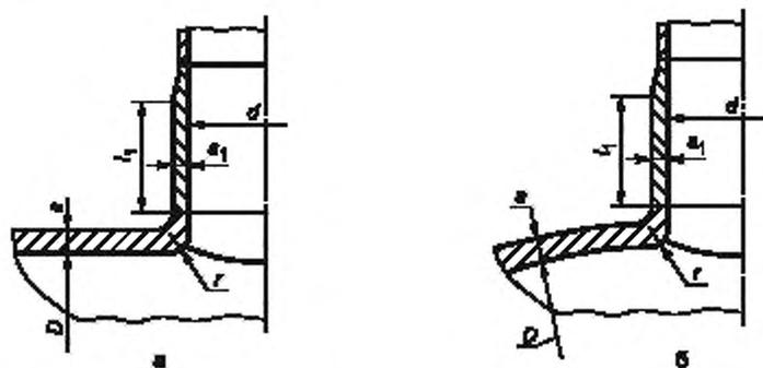
Рисунок А.6 — Укрепление отверстий отбортовкой
