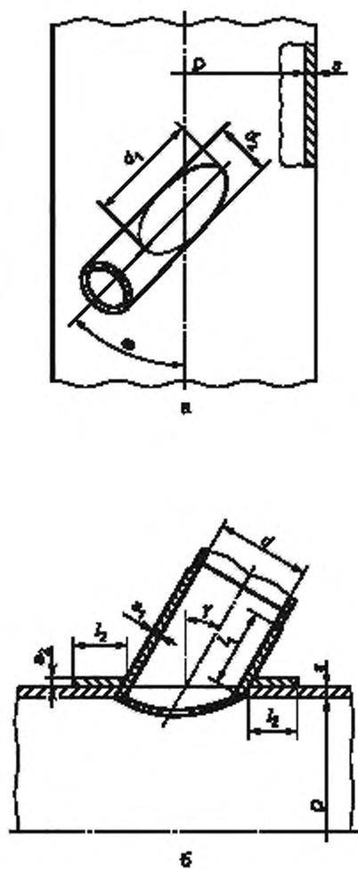
Рисунок А.11 — Наклонные штуцеры на обечайке
