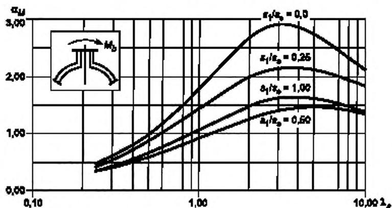
Рисунок Б.11 — Коэффициенты концентрации  $\alpha_M$  в месте пересечения штуцера со сферической оболочкой при нагружении штуцера изгибающим моментом в зависимости от  $\lambda_s$  и отношения  $s_1/s_2$
