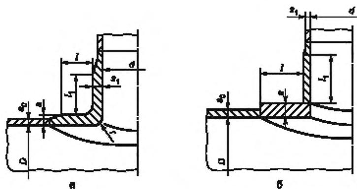
Рисунок А.7 — Укрепление отверстий торообразной вставкой
